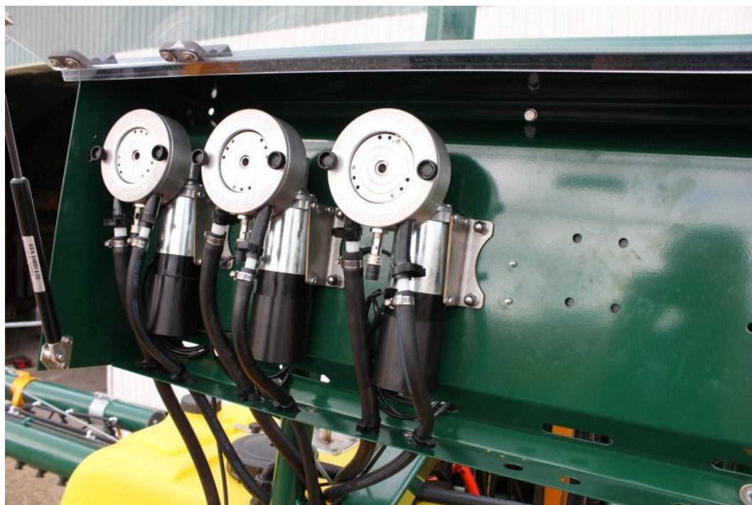
Billede 1. De tre doseringspumper er monteret i et skab, der er synligt fra førersædet. Herved kan føreren se, om pumperne arbejder.
