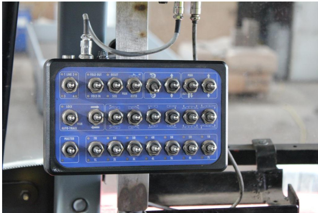
Billede 10. Styring for manuel betjening af bomsektioner, tænd/sluk, blæserhastighed mv.
