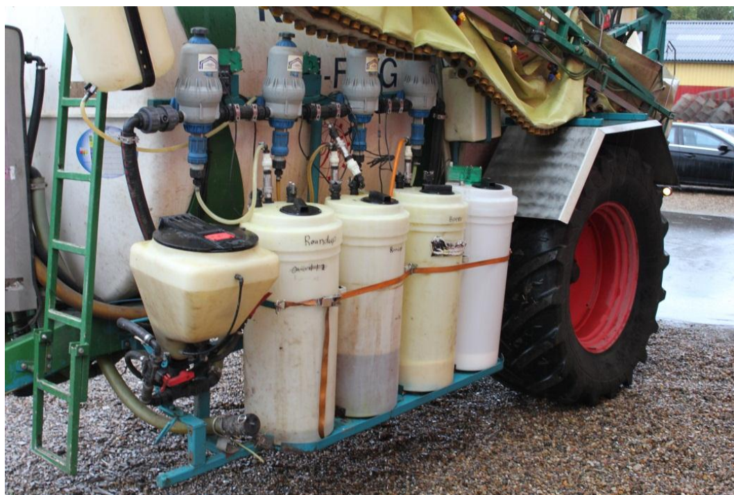
Billede 6. Beholderne er placeret umiddelbart under injektionspumperne.
