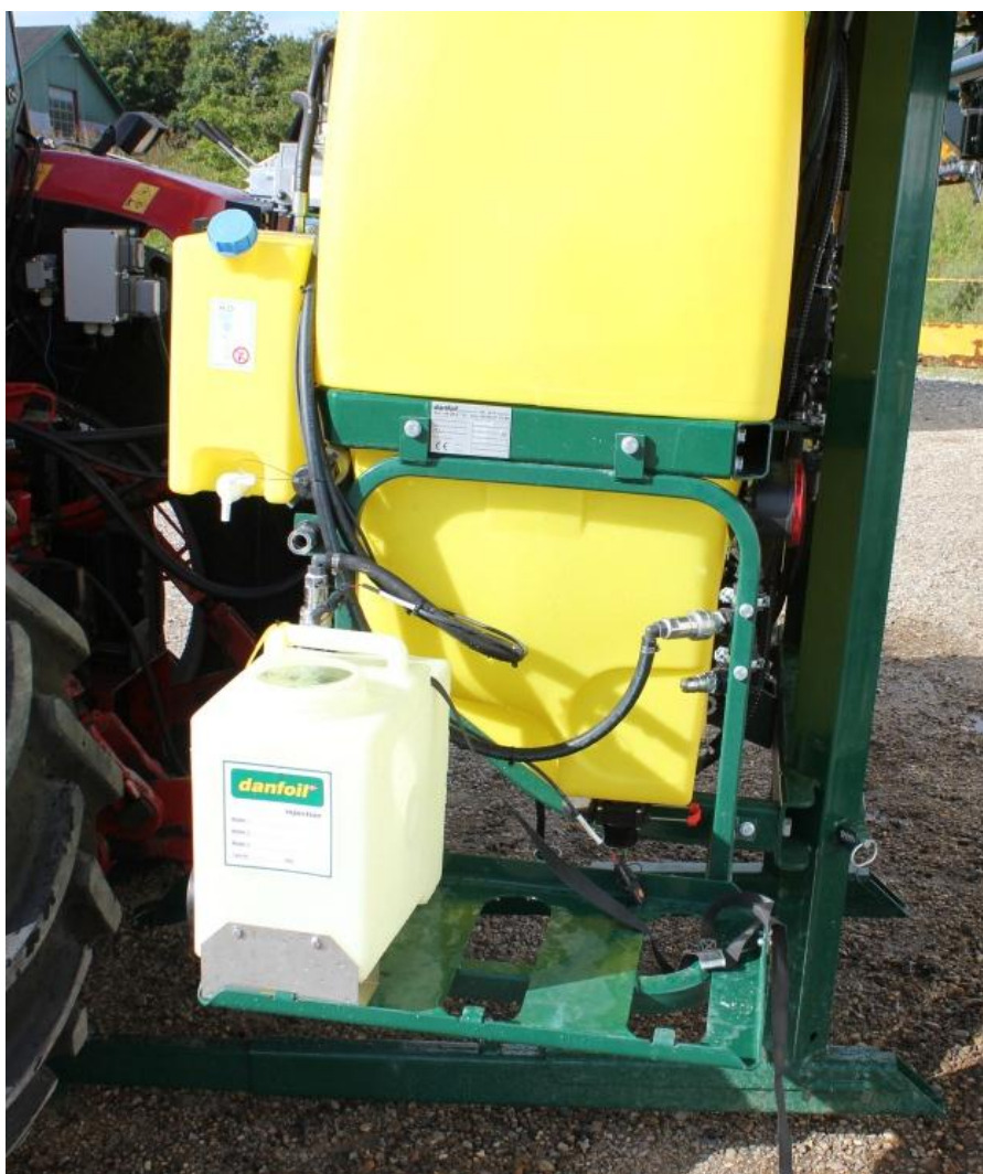
Billede 2. På billedet ses en 28 l tank uden omrøring. Hver ramme gør det muligt at medbringe tre 28 l-tanke eller en 100 l-tank og en 28 l-tank.
